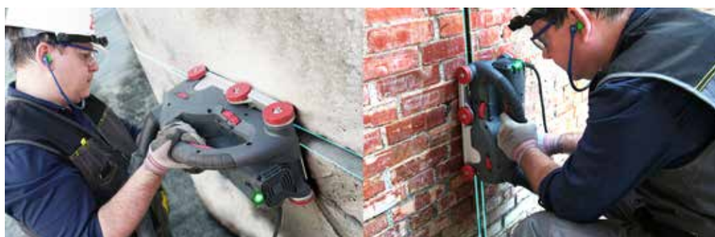
b Diamantový řezný kotouč (tvrdé materiály)
